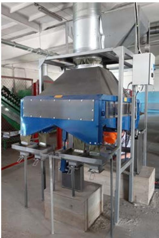
Рис. 4. Общий вид прямоточного вибропневматического сепаратора
