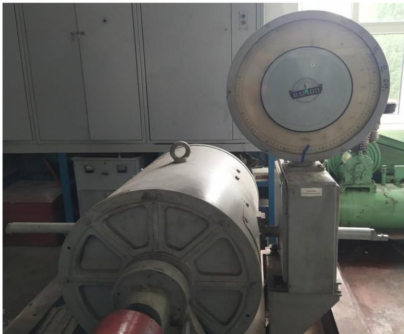
Рис. 1. Нагрузочный стенд RAPIDO
