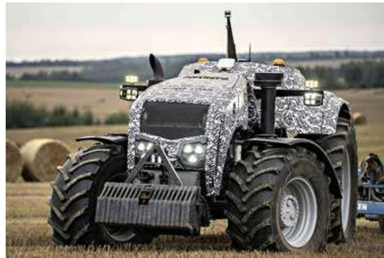
Предназначен для выполнения заданий, которые могут передаваться удаленно через сотовую связь или же на съемном носителе. Машина также оснащена GPS-навигацией и системой точного земледелия.
