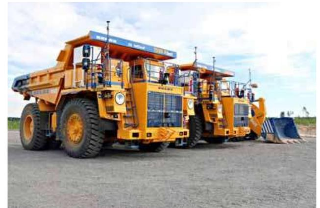
**130-тонный гибридный самосвал с инновационной схемой работы, сочетающий дизельный двигатель малой мощности с аккумуляторными батареями и системой рекуперации энергии(ОАО «БЕЛАЗ»)**
