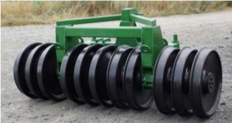
Рис. 3. Каток для трамбовки сенажа
