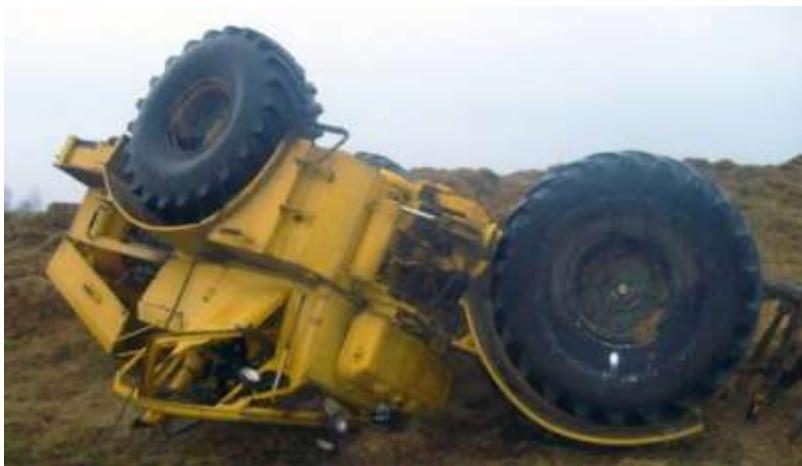
Рис. 1. Опрокидывание трактора К 700 при трамбовке сенажа
