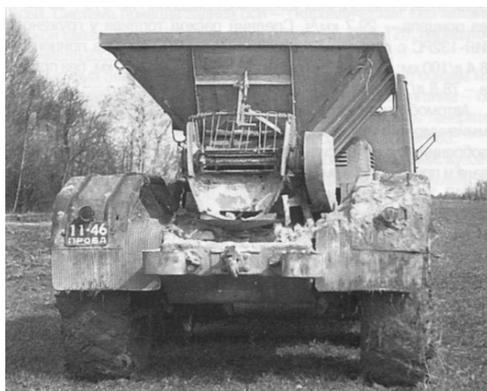
Рис. 4. Подкормка озимых ранней весной – автомобиль практически не образует колею [7]
