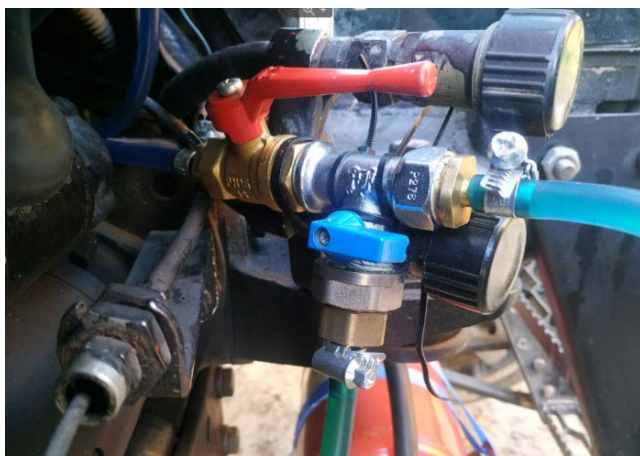
Рис. 1. Внешний вид топливной системы для приготовления и подачи многокомпонентного биотоплива: a – дополнительный бак со встроенным рециркуляционным насосом; б – тройник с кранами для регулировки подачи дизельного топлива и многокомпонентного топлива
