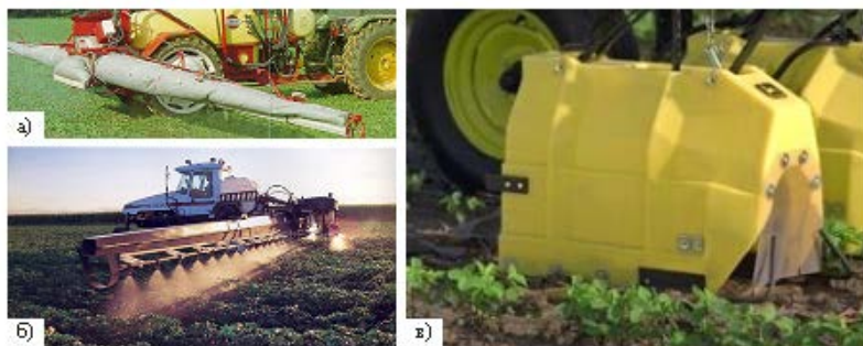
Рис. 2. Системы, снижающие снос рабочих растворов при опрыскивании: а – система принудительного воздушного осаждения капель; б – электростатическая система распыливания; в – ветрозащитные устройства
