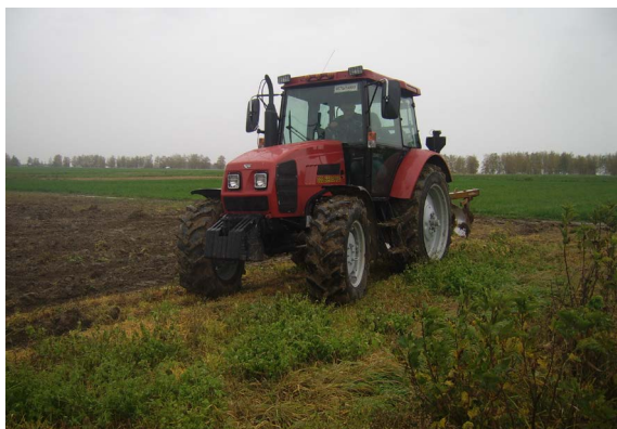
Рис. 1. Испытания работы трактора Беларус-922 на альтернативном топливе
