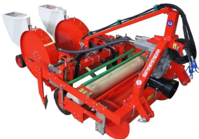
Рис. 8. Комбинированная машина для посева с мульчированием пленкой Spapperi SMP
