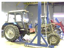
Рис. 5. Специализированные стойки и балки
