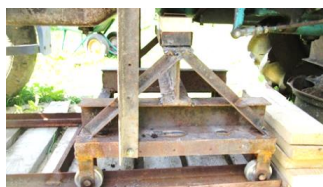
Рис. 1. Устройство раскатки из гидравлического домкрата и сварной рамы
