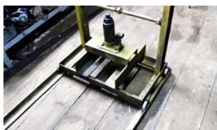
Рис. 1. Устройство раскатки из гидравлического домкрата и сварной рамы
