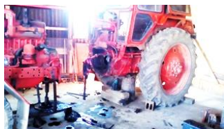
Рис. 2. Устройство раскатки из гидравлического домкрата и сварной рамы
