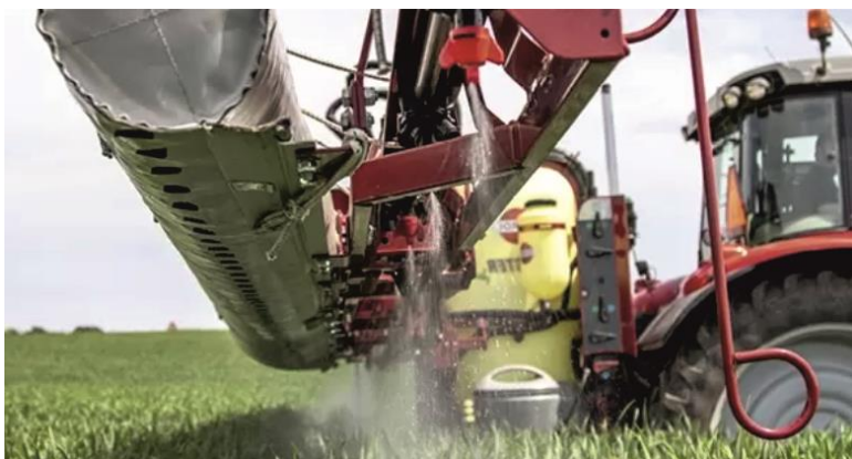
Рис. 1. Ветрозащитные устройства активного действия
