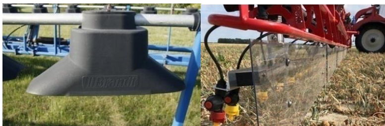
Рис. 2. Ветрозащитные устройства пассивного действия
