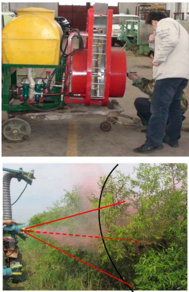
Рис. 3. Опрыскиватель и испытание характеристик распыления
