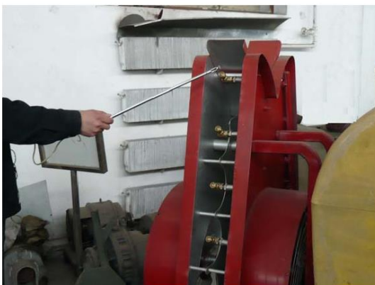
Рис. 2. Устройство для измерения скорости ветра
