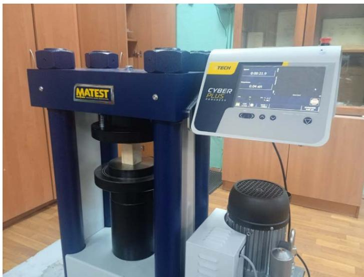
Рис. 1. Испытание образцов на сжатие вдоль волокон
