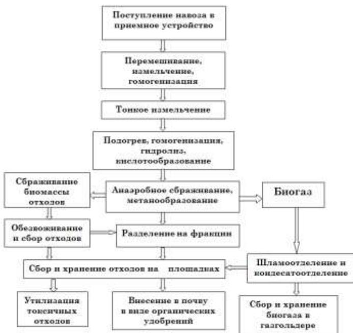
Рис. 1. Принципиальная пооперационная схема переработки навоза в биогаз
