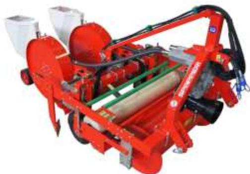
Рис. 2. Комбинированная машина для посева с мульчированием пленкой Sparger SMP
