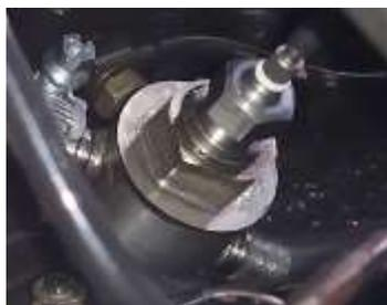
Рис. 1. Датчик динамического давления PS01
