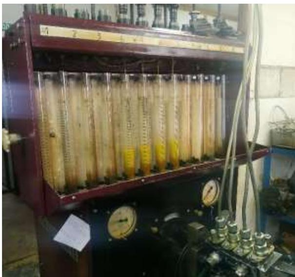
Рис. 1. Исследование многокомпонентного биотоплива на стенде КИ-22210-02М-11
