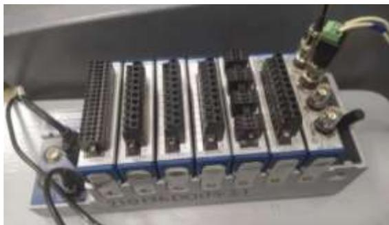
Рис. 3. Модуль сбора данных NI CompactDAQ
