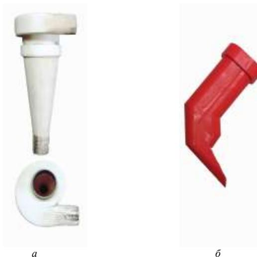
Рис. 1. Части устройства для повышения равномерности распределения семян вдоль рядка:
