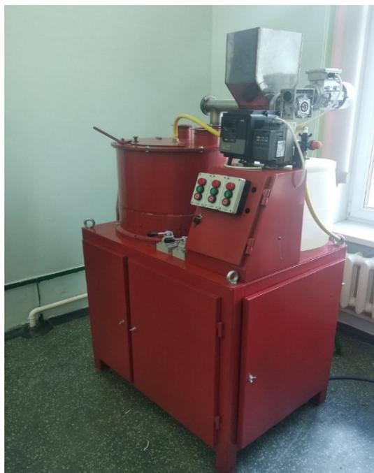
Рис. 1. Экспериментальный дражировщик семян
