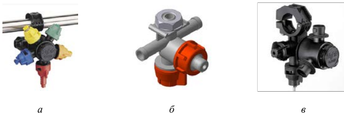
Рис. 7. Различные виды корпусов узла распыла: а – корпус с пятью распылителями для опрыскивающей штанги со шлангом внутри; б – корпус проходной с одним распылителем для опрыскивающей штанги с отсечным устройством; в – корпус для трех распылителей для опрыскивающей штанги со шлангом внутри
