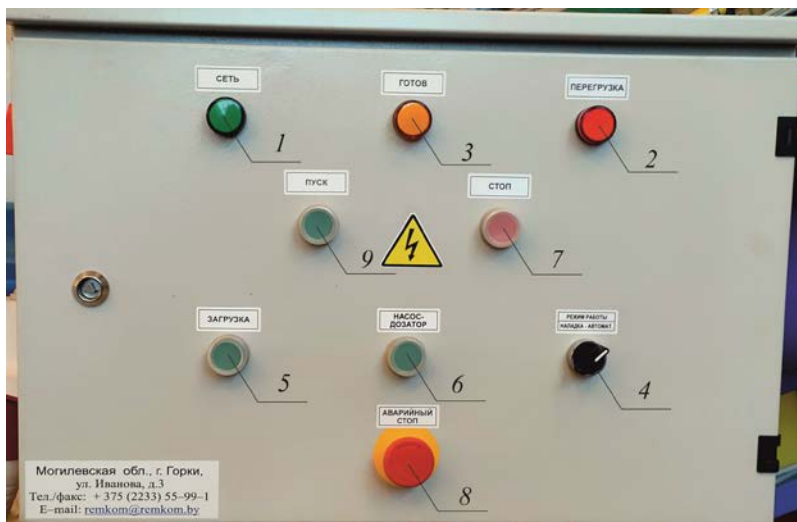
Рис. 4. Пульт управления: 1 – лампочка «Сеть»; 2 – лампочка «Перегрузка»; 3 – лампочка «Готов»; 4 – переключатель режимов работы; 5 – кнопка «Загрузка»; 6 – кнопка «Насос-дозатор»; 7 – кнопка «Стоп»; 8 – кнопка аварийного отключения; 9 – кнопка «Пуск»
