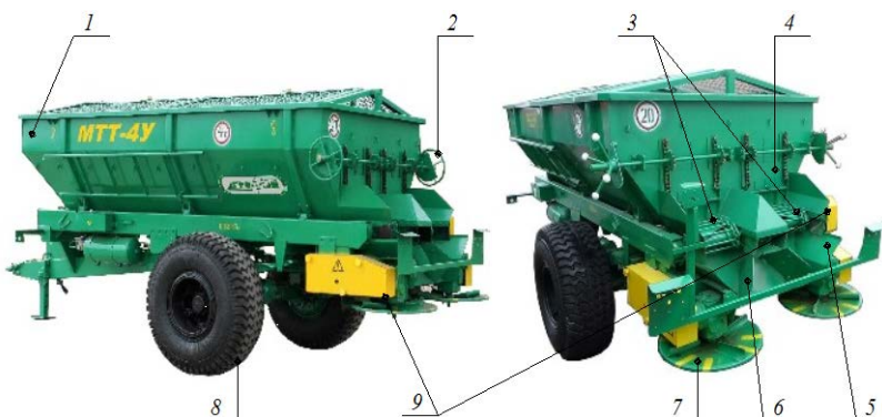
Рис. 11. Общий вид рассеивателя МТТ-4У: 1 – кузов; 2 – механизм регулировки дозирующих заслонок; 3 – подающий конвейер (транспортёр); 4 – дозирующая заслонка; 5 – лоток-туконаправитель; 6 – тукоделитель; 7 – разбрасывающий механизм; 8 – ходовое устройство; 9 – трансмиссия
