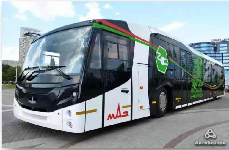
Образец электробуса для перевозки пассажиров в аэропортах с компонентами силовой установки отечественного производства.
