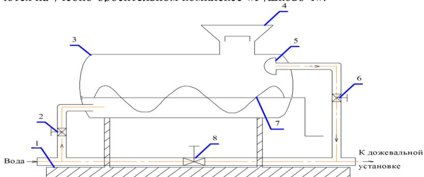
Рис.1. Модернизированный гидроподкормщик на базе ДДН-100.
