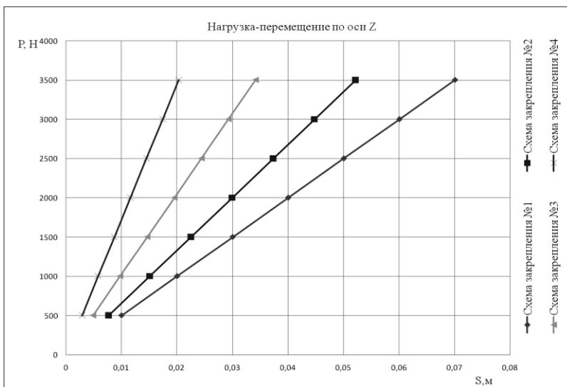
Рис. 2. Нагрузка-перемещение по оси Z (от схемы закрепления), ось Z соответствует глубине обработки
