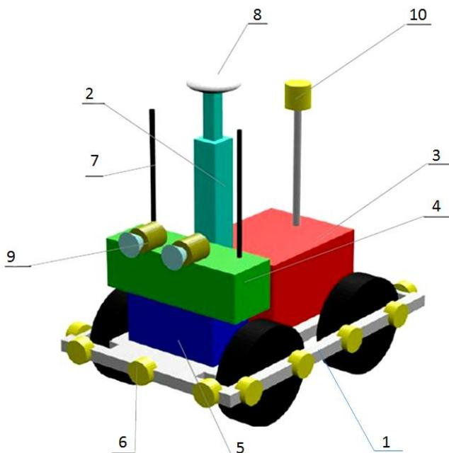
Рис. 1. Автоматизированный почвенный пробоотборник (АПП)
