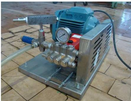
Рис. 1. Экспериментальная установка высокого давления на базе насоса P20/15-160RE с вихревым гомогенизирующим устройством
