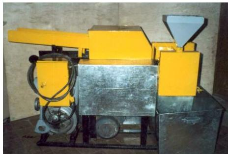
Рис. 3. Комбинированная установка для измельчения кормов
