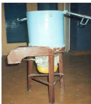
Рис. 1. Корнерезка
